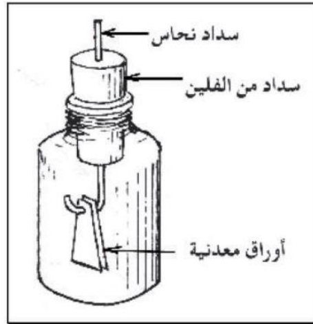
شكل (٥:٣) كشاف كهربائي
