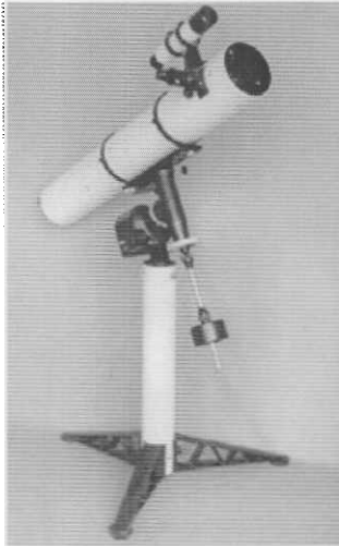
منظار فلكي مركب عليه منظار فلكي آخر صغير يستعمل للتوجيه للمنطقة المراد رؤيتها مكبرة
